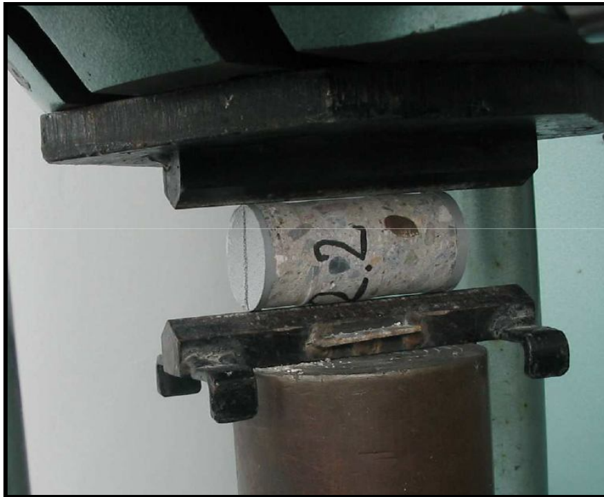
Figura 4. Exemplu de carotă supusă încercării la despicare 12
