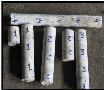
Figura 2. Exemple de carote extrase din betonul armat 9
