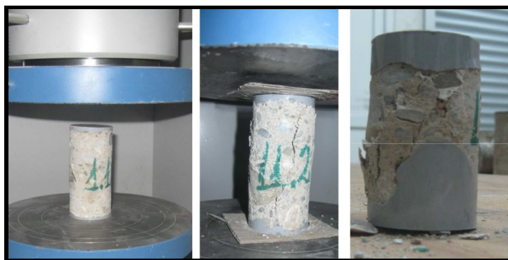
Figura 3. Exemple de carote supuse încercării la compresiune 10
