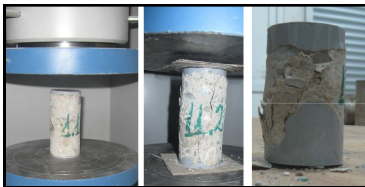
Figura 3. Exemple de carote supuse încercării la compresiune 10
