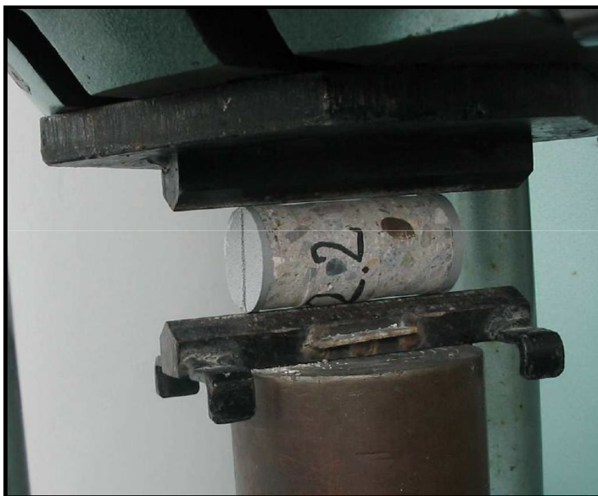
Figura 4. Exemplu de carotă supusă încercării la despicare 12
