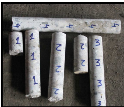
Figura 2. Exemple de carote extrase din betonul armat 9
