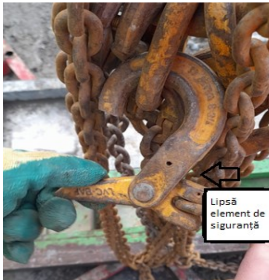
Figura 1 Cârlig căruia îi lipsește siguranța achiziționate
